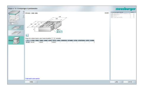
Por último, llega al asistente habitual para componer portamoldes, en el que puede seleccionar el material de la placa del distribuidor, así como el resto de placas y componentes del portamoldes.
