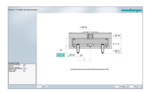
En el paso número 3 introduzca las medidas del molde de cámara caliente. También puede modificar el diámetro de las boquillas. El configurador preselecciona la boquilla más apropiada.
