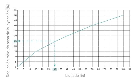
Ejemplo: 30 % de carga, el peso de la inyección se reduce un 25 %
